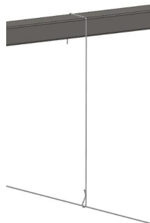
Suspensión de una viga
